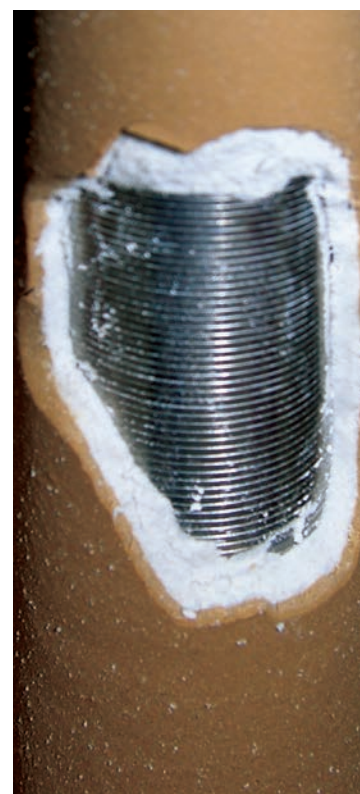
Ukázka rovnoměrného naplavení jednotlivých vrstev křemeliny na svíčke
